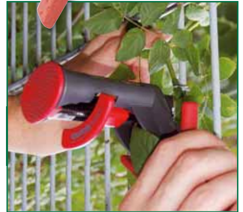
Wichtig bei der Arbeit mit der Zange ist die Einstellung der richtigen Ösengröße, um die Äste nicht zu quetschen
