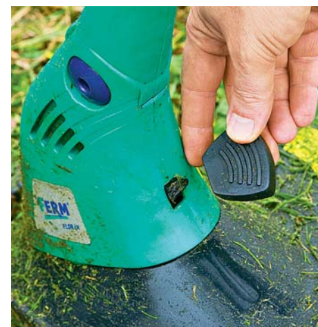
GEBROCHEN: Der Fußschalter für die Verstellung der Neigung brach im Praxistest schon zu Beginn ab
