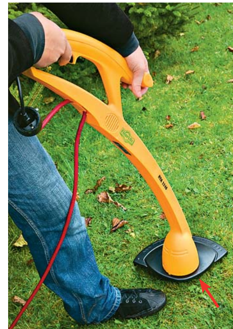
FALSCH MONTIERT: Im Praxistest wurde die Abdeckung (Pfeil) am Fleurette-Trimmer falsch montiert: Gefahr!
