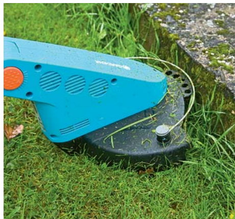
SCHUTZBÜGEL: Er hält Hindernisse auf Abstand und schützt Pflanzen vor Verletzungen durch den Schneidfaden
